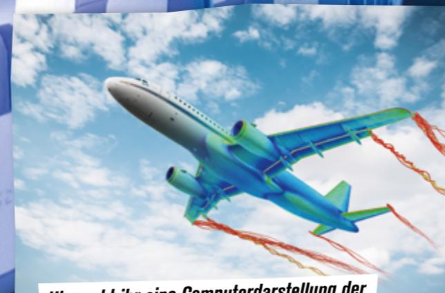
**Hier seht ihr eine Computerdarstellung der Wirbelströmung an einem Airbus A320 des DLR.**
