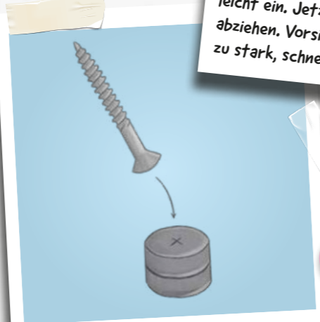
2 Legt die beiden Magnete aufeinander. Platziert die Schraube mittig mit dem Kopf nach unten auf die beiden liegenden Magnete. Die Schraube sollte jetzt von den Magneten angezogen werden und so stehen bleiben.
