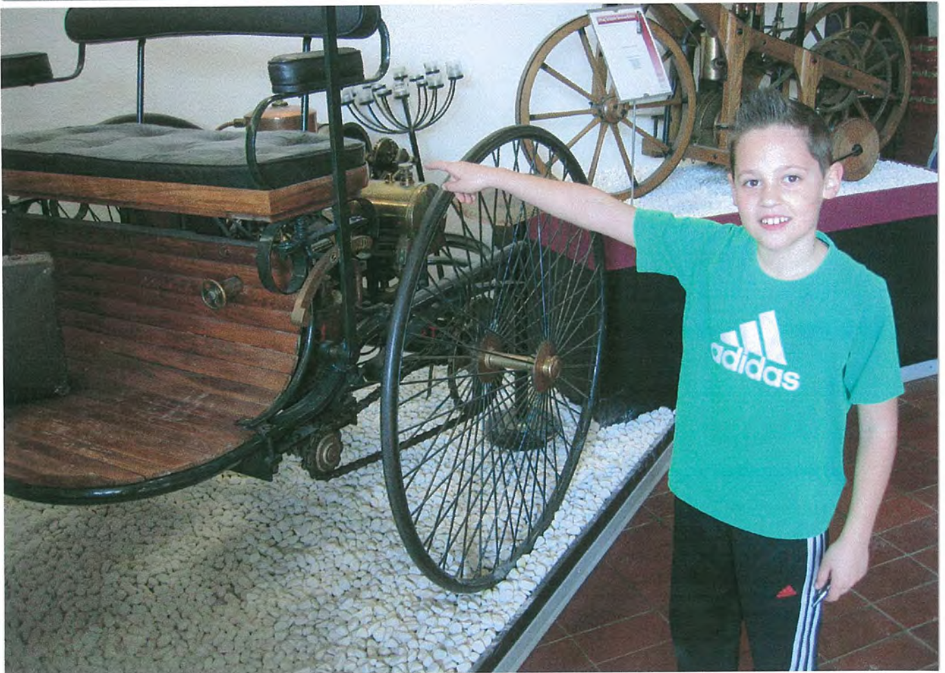
Cano zeigt auf den Nachbau des „ersten Automobils der Welt Baujahr 1885 von Benz“ der mit Gasmotor und drei Rädern ausgestattet war. Er besaß 0,8 PS, einen Einzylinder Viertaktbenzinmotor, Batteriezünd.
